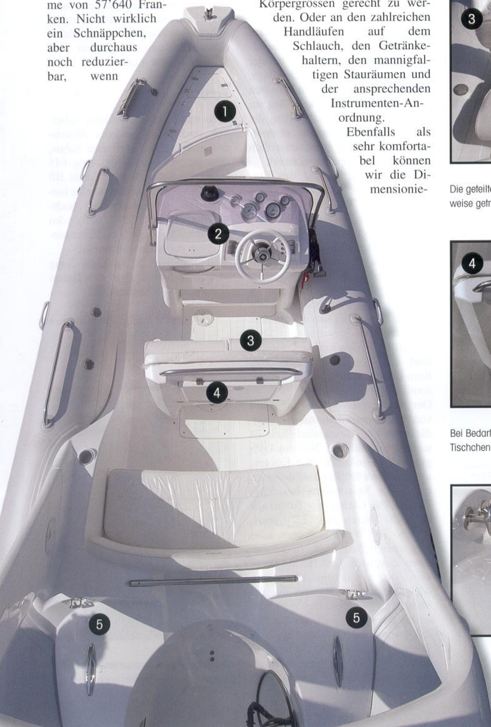
Wasserski-Zugösen und versenkbare Klampen sind aus Edelstahl, richtig angeordnet und vernünftig dimensioniert.
