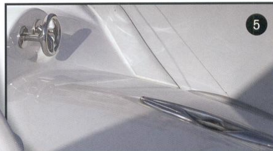
Wasserski-Zugösen und versenkbare Klampen sind aus Edelstahl, richtig angeordnet und vernünftig dimensioniert.
